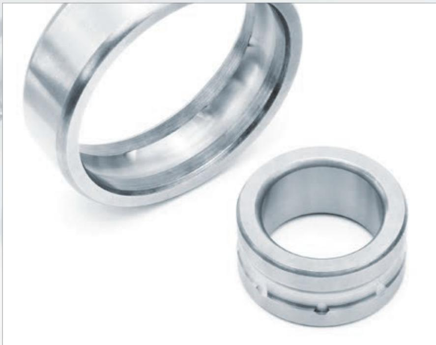
Fig. 16 : Éléments roulants - chemins de roulement endommagés par un montage incorrect.
