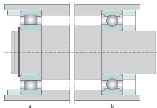
**Fig.5** : Exemple de palier fixe / palier libre
