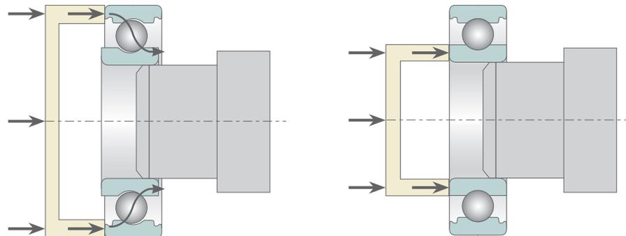
Montage incorrect, introduction des forces par les éléments roulants
