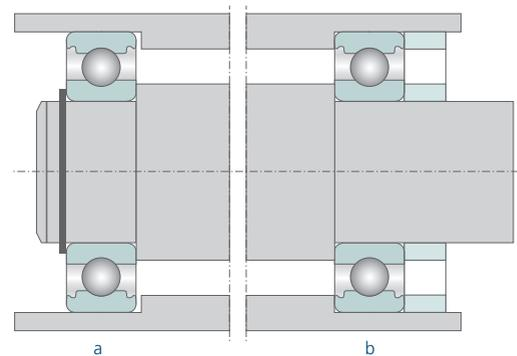
**Fig.4** : Exemple de palier fixe / palier libre
